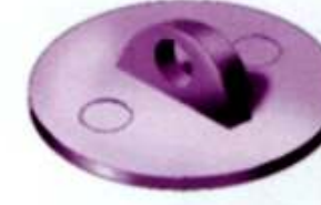
24. Knockout Pin Marks
